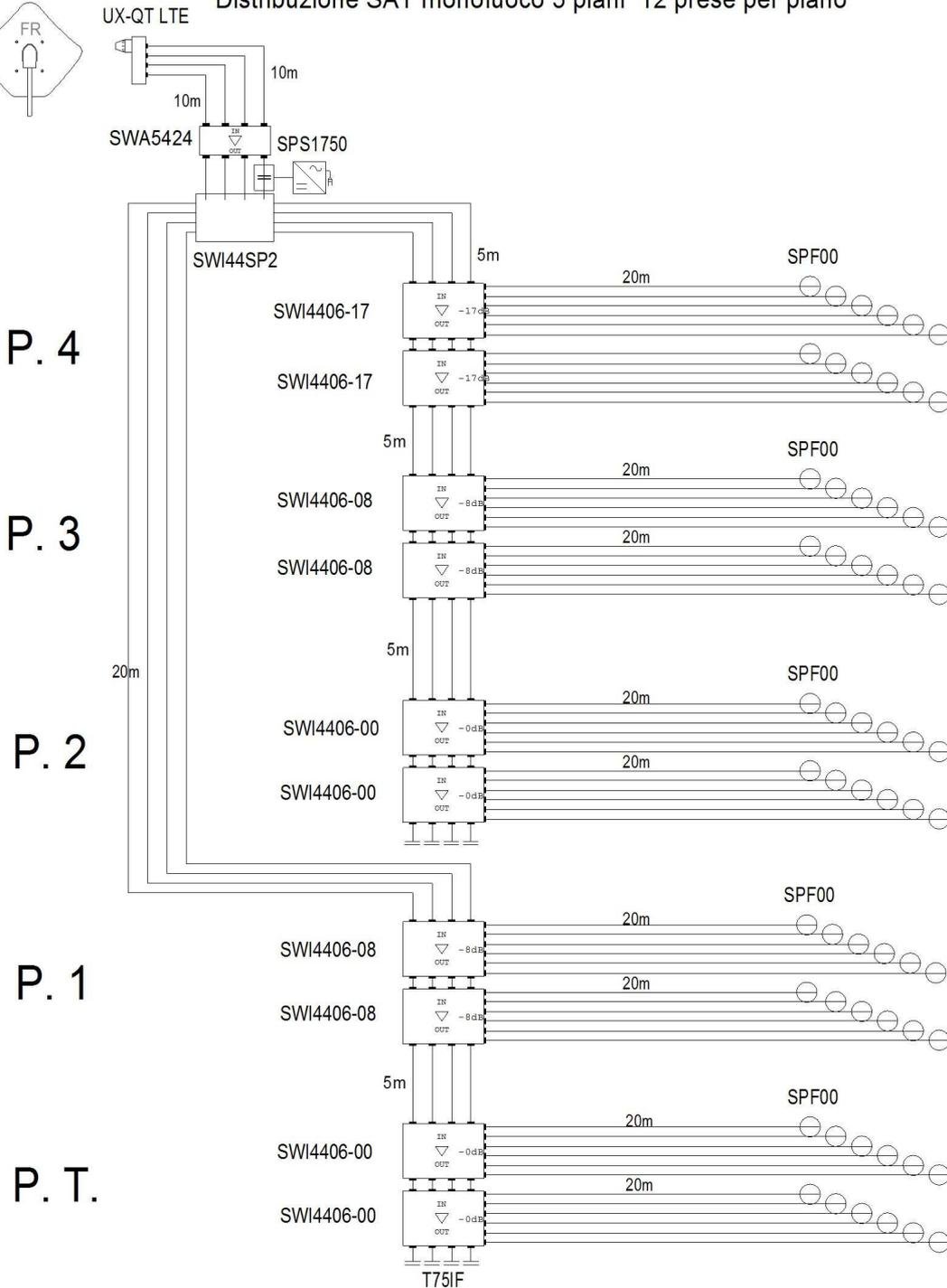
L'indicazione delle antenne, dei supporti porta-antenna e dei preamplificatori da palo nello schema è puramente indicativa, in quanto la scelta dipende esclusivamente dalla tipologia di segnale TV ricevuto nella zona di realizzazione dell'impianto e dalla struttura dello stabile
